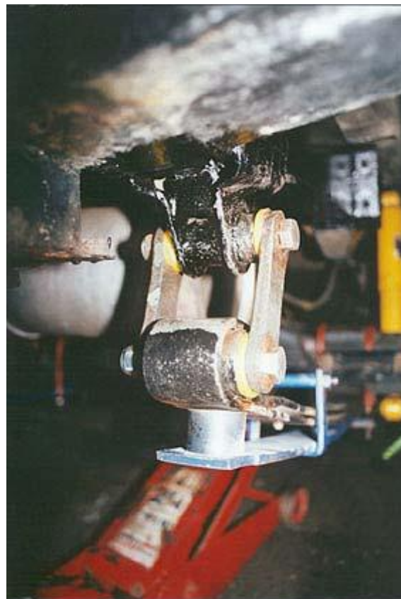
Stap 9 Op deze foto is de volgende stap te zien. Het verwijderen van de bussen uit het chassis. Op zich geen probleem, zelfde principe. Let wel op, dat het draadeind voldoende ruimte blijft houden tot het motorblok!
